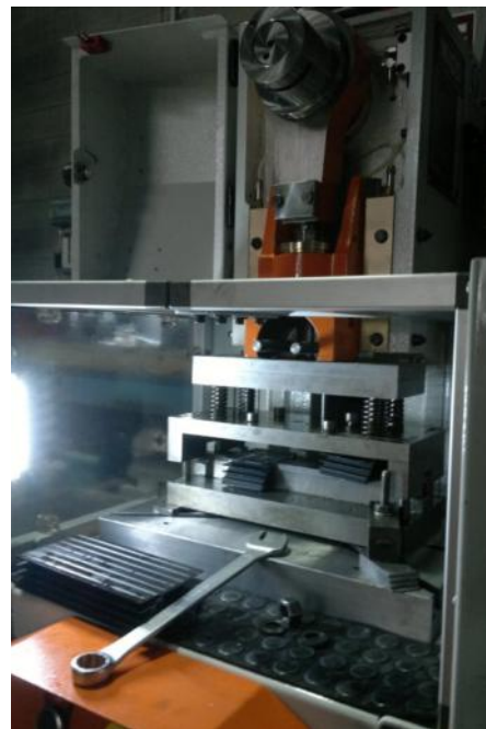
FOTO DI ESEMPIO: SI ESEGUONO OPERAZIONI DI TRANCIATURA SU PROFILI ESTRUSI IN ALLUMINIO
